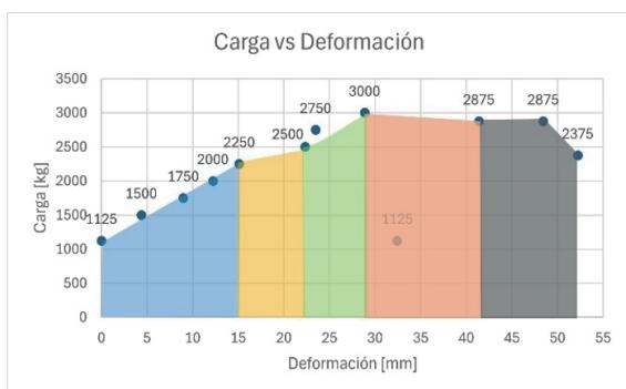
**Nota.** El gráfico representa el comportamiento del muro de acuerdo con su desplazamiento ubicado por zonas**Figura 2***Gráfica de carga versus deformación en el tercer ciclo del ensayo del muro o*
