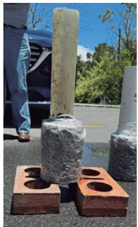
**Nota.** La probeta aforada, permite observar la filtración en el concreto permeable.
