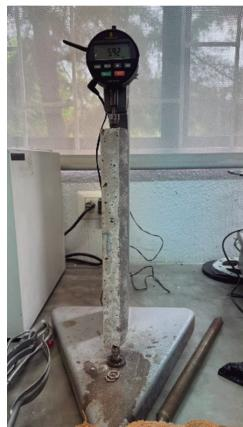
**Nota.** Esta medición indica la expansión o contracción de las barras de mortero.
