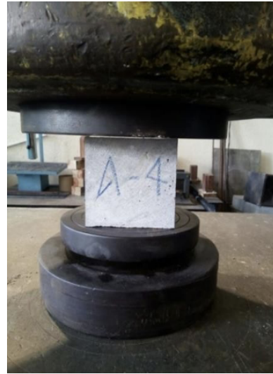
Figura No. 3. Adoquín sometido a ensayo a compresión
