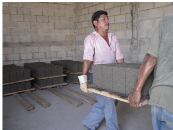
Figura No. 1. Fabricación de bloques de concreto en la planta de producción
