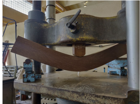
Figura 2. Ensayo de Flexión para determinación del módulo de ruptura
