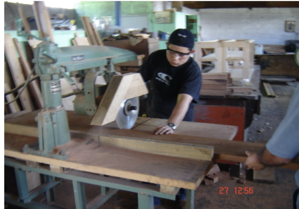
Figura No. 1: Proceso de corte transversal para la elaboración de bastidores
