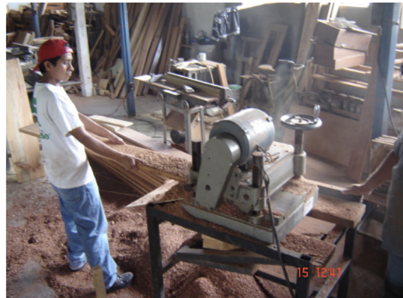
Figura No. 4: Cepillado de madera en dimensiones para la edificación de muros
